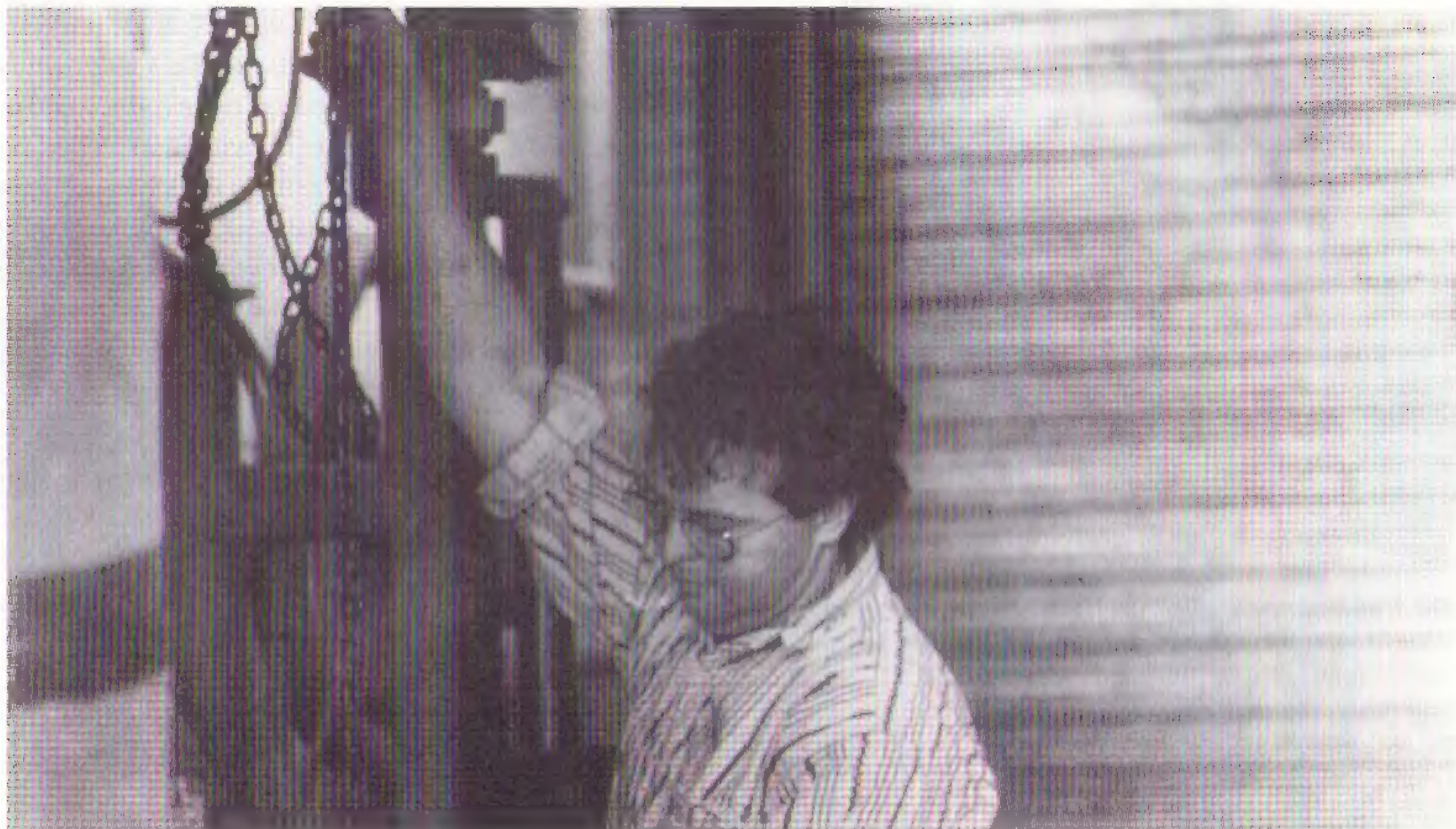
De fabrikant, Koos Schenk, plaatst de ruwe baskast onder de slijpmachine.
